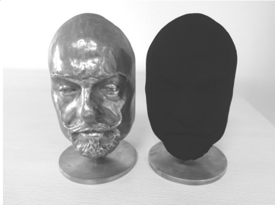
Figuur 8: Kunst van Surrey NanoSystems met een coating van Vantablack
